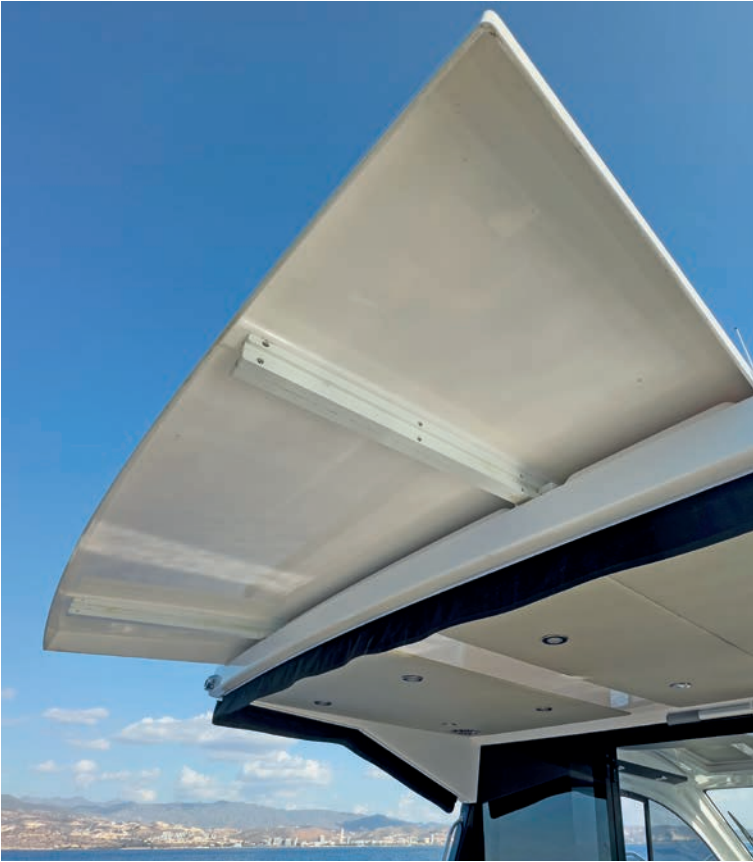
Elektrycznie rozsuwany dach chroniący kokpit rufowy.
